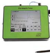
Pile Integrity Tester (PIT) Ispitivanje integriteta
